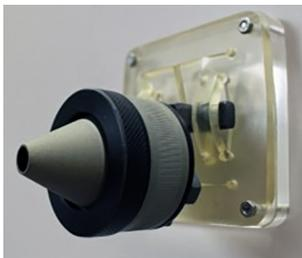
**Abb. 1** Probenahmekopf GSP [5]
