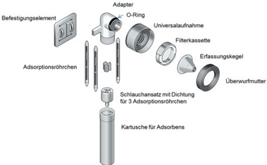
Abb. 11 Schematischer Aufbau des GGP-Systems (Personenbezogenes Gefahrstoff-Probenahmesystem) – GGP-U für E-Staub und Gas-Probenahme [37]
