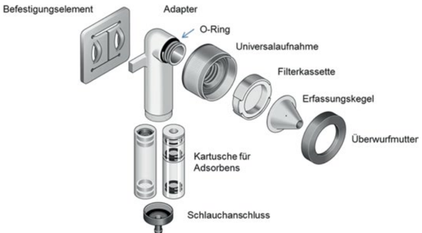
Abb. 10 Schematischer Aufbau des GGP-Systems mit Glas- oder Kunststoffkartusche zur Aufnahme von Adsorbens [38]
