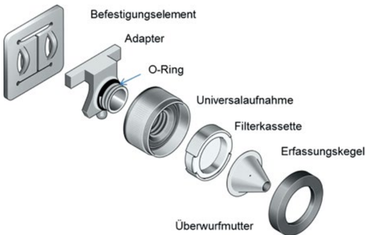
Abb. 9 Schematischer Aufbau des GSP Probenahmekopfes
