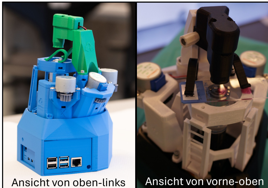
Abbildung 4: Von Studierenden gebaute, 3-achsige motorisierte Durchlichtmikroskope
